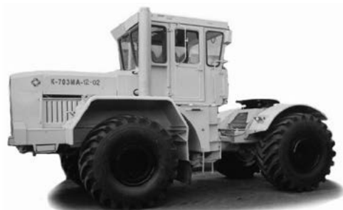
Рис. 16. К-700 «Кировец» – колесный трактор общего назначения повышенной проходимости, тяговый класс 5. Главный конструктор – Ж. Котин. Выпускался Кировским заводом с 1964 по 2002 год (общий выпуск К-700, К-701, К-702, К-703 – около 400 тыс.). В качестве прототипа для первой модели был использован канадский трактор Wagner
